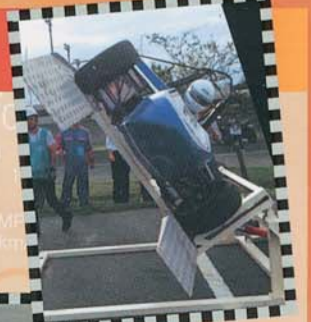
▲チルト試験を受けるEVマシン
