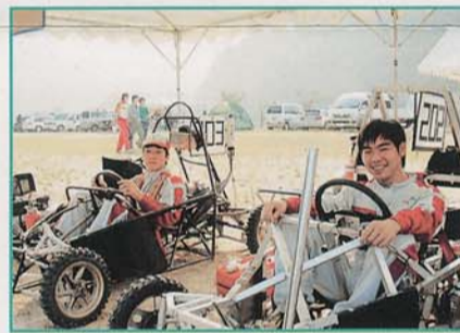
ゼロハンカーとは: 50CCのミニバイク用エンジンを自作のフレームに搭載したレース専用車両のこと
