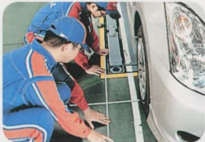
ガイド付リフトによる安全作業の検証
